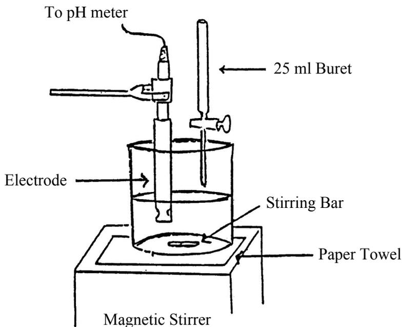
Fig. 3. Apparatus for Potentiometric Titration
