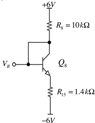
$$I_{C8} = \frac{12V - 0.6V}{10k\Omega + 1.4k\Omega} = 1mA$$
