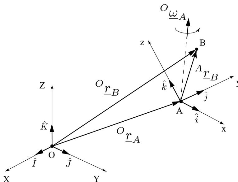
$${}^O\underline{V}_B = {}^O\underline{V}_A + {}^A\underline{V}_B|_{{}^O\underline{\omega}_A=0} + {}^O\underline{\omega}_A \times {}^A\underline{r}_B \quad (1)$$
