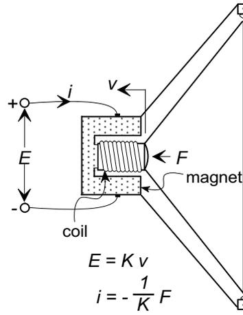
(d) Moving-coil loudspeaker
